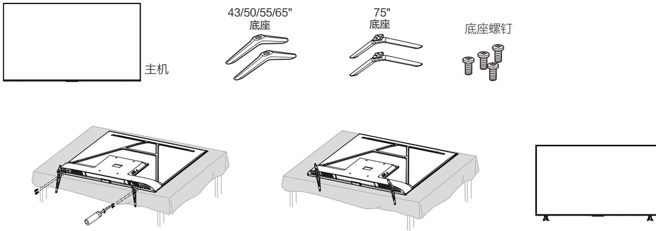
注：固定底座螺钉或相应塑胶件禁止接触油脂及有机溶剂。
