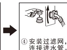
④安装过滤网，连接进水管。
