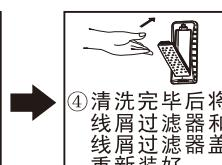
④清洗完毕后将线屑过滤器和线屑过滤器盖重新装好。
