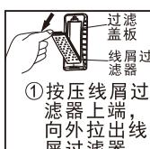
①按压线屑过滤器上端，向外拉出线屑过滤器。
