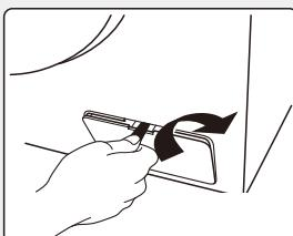
用薄片如硬币等按图示方向拆下排水泵保护盖；
