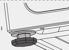
注意：为便于安装，底脚出厂状态可能没有全部锁死，请在调节水平之前，
