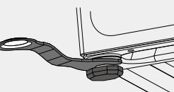
②机器放置完毕后，双手依次按住洗衣机顶盖板的对角，垂直向下用力晃动，检查支撑底脚是否紧贴地面，机器是否晃动；
