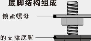
橡胶包裹的支撑底脚
