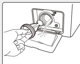
慢慢拧下排水泵的泵盖（注意残水），取出泵内的衣物残渣并彻底清洁，直至叶片可以自由转动；
