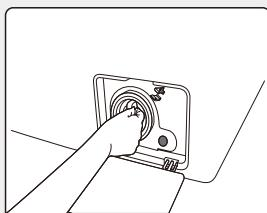
装上排水泵的泵盖并拧紧，确保排水泵不漏水，如图。装上排水泵保护盖！
