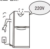
必须使用独立专用插座并进行可靠接地。本系列产品电源线配有三线（接地）插头，与标准三线（接地）插座匹配。任何情况下，切勿切除或拆除电源的第三插脚（接地）。
