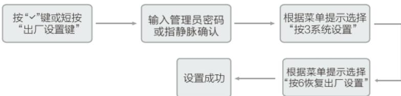
注意：另外通过长按门锁“设置键”5S以上也能实现恢复出厂设置功能，同时出厂设置会清除当前门锁所有登记过的密码、指静脉、卡片等ID信息，同时所有菜单将会恢复默认出厂状态。出厂状态下激活门锁，按指静脉、密码、卡片开门门锁将会语音提示“请注意，您的锁没有用户注册。请尽快注册管理员”。注意恢复出厂完成需要同步TCL智慧物联平台进行同步更新。
