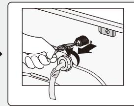
从机器的背面拧下进水管，用尖嘴钳拔出过滤网，清洗后装回；
