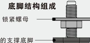
橡胶包裹的支撑底脚
