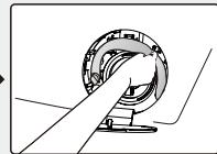
装上排水泵的泵盖并拧紧，将旋钮保持垂直，如图。将紧急排水管固定回原处，装上排水泵保护盖！
