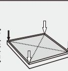
③保证机器放置状态，用随机附带的扳手按照图示方向松开锁紧螺母至合适高度，直至保证支撑底脚紧贴地面、机器无晃动；
