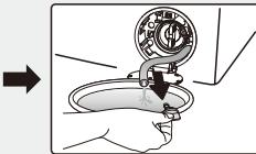
将紧急排水管从固定处取出，拔下紧急排水管塞子，将残留的水排出，排水结束后装回塞子；
