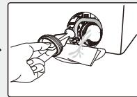
慢慢拧下排水泵的泵盖，取出排水泵内的衣物残渣，并彻底清洁，直至叶片可以自由转动；
