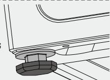
注意：为便于安装，底脚出厂状态可能没有全部锁死，请在调节水平之前，
