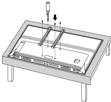
② 用挂架螺钉固定上面的两个挂架孔，
