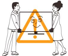
移动电视机时，请确认插头从电源插座上拔下并断开天线、音频/视频连接线及任何固定线的连接。移动电视机时，至少需要两个人，务必直立搬动。勿使电视屏幕向上或向下。
