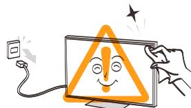
清洁前请拔掉电源插头。请勿使用汽油或稀释剂等溶剂来清洁电视机。这些溶剂可能会使外壳变形或漆面受损。
