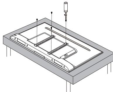
② 用挂架螺钉固定上面的四个挂架孔，
