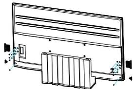
2、拆掉锁左右侧盖的12个螺丝，并把左右侧盖取下来
