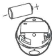
请按电池的正负极正确更换电池，注意环保，正确处理废旧电池。
