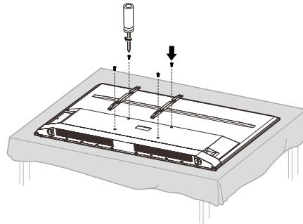
② 用VESA螺钉 ( M6\*23 ) 将挂架锁到电视整机上
