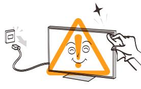
清洁前请拔掉电源插头。请勿使用汽油或稀释剂等溶剂来清洁电视机。这些溶剂可能会使外壳变形或漆面受损。
