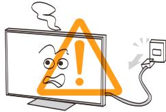
电视机发生故障、冒烟或发出异味时，请立即关闭电视机，并从插座上拔下电源插头。确认烟雾和异味已消失后，请联系维修技术人员。
