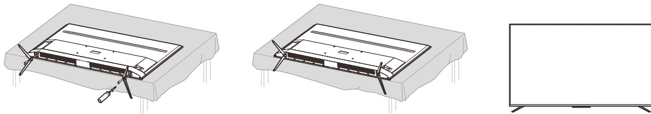
注：固定底座螺钉或相应塑胶件禁止接触油脂及有机溶剂。
