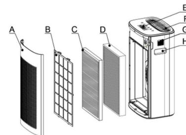
A、进风盖； B、预过滤网； C、中效过滤网； D、复合高效过滤网；
