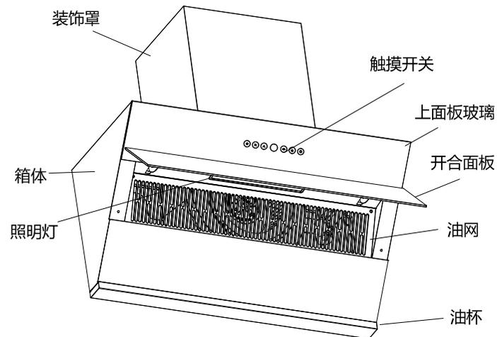
(此图为通用结构示意图, 仅供用户识别零部件的位置, 如图形与实物不符, 请以实物为准, 谨以致歉!)
