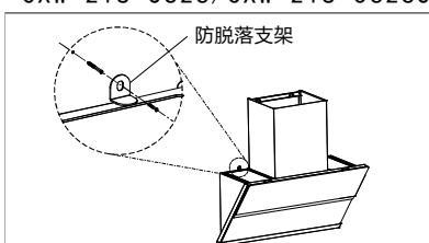
在机身顶板对应墙面的位置钻1个 $\varnothing 10$ 孔，打入 $\varnothing 10$ 膨胀管，用ST5X50自攻螺钉将防脱落支架固定到墙面上。
