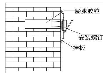
**安装挂板:**在3个打孔处将随机附带的膨胀胶粒塞入孔内，再用ST5X50自攻螺钉紧固挂板。
