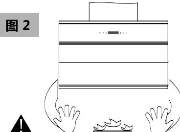
**警告：**严禁炉火直接烘烤吸油烟机和避免使油锅着火，以免将火焰吸入机体内损坏吸油烟机及发生意外。
