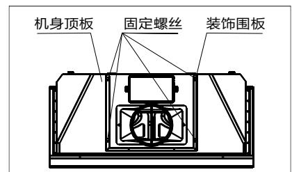
**安装装饰围板：**把装饰围板套上机身顶板，对应螺丝孔拧紧螺丝固定好。
