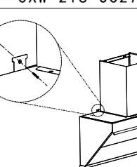
将配件包里的2粒M4×16限位螺钉分别固定到挂板左右两侧的限位孔上。
