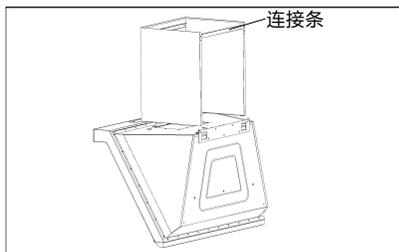
**安装连接条:** 把连接条用2粒M4X8螺丝固定在装饰围板上。
