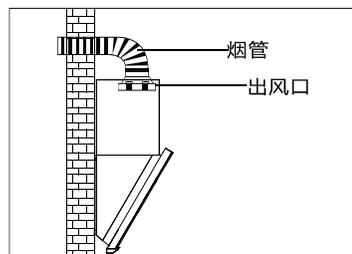
**安装风管:**将烟管插入出风口座的槽内, 用ST4X12大扁自攻螺钉紧固, 最后将风管拉直至室外或公共烟道中。
