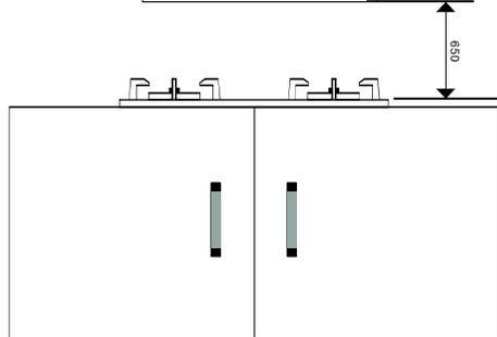
**确定位置:**按上图尺寸所示在墙面找出固定件的安装位置, 钻3个孔, 孔深50mm, 孔径10mm(不可过大)。
