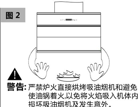
**警告:** 严禁炉火直接烘烤吸油烟机和避免使油锅着火,以免将火焰吸入机体内损坏吸油烟机及发生意外。
