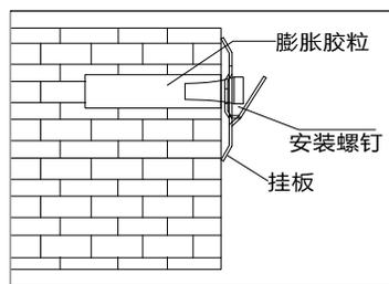
**安装挂板:**在3个打孔处将随机附带的膨胀胶粒塞入孔内, 再用ST5X50自攻螺钉紧固挂板。
