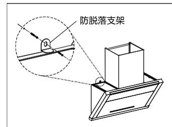
将吸油烟机挂在墙面的挂板上, 请确保吸油烟机无晃动和脱挂现象, 使吸油烟机处于水平状态, 然后将配件袋里的防脱落支架在机身顶板对应墙面的位置钻1个 $\phi 10$ 孔, 打入 $\phi 10$ 膨胀管, 用ST5X50自攻螺钉将防脱落支架固定到墙面上防止吸油烟机意外脱落。
