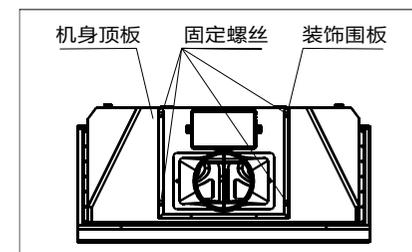
**安装装饰围板:** 把装饰围板套上机身顶板,对应螺丝孔拧紧螺丝固定好。
