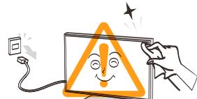
清洁前请拔掉电源插头。请勿使用汽油或稀释剂等溶剂来清洁电视机。这些溶剂可能会使外壳变形或漆面受损。如果橡胶或乙烯基制品与电视机长期接触，可能会留下污迹。如果外壳变脏，请用柔软干布擦拭。清洁液晶显示屏的表面时，请用柔软的干布轻轻擦拭液晶屏表面。
