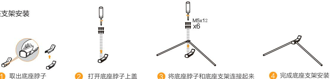
注：固定底座螺钉或相应塑胶件禁止接触油脂及有机溶剂。
