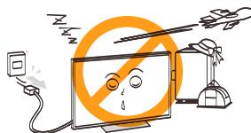
电视机长期不使用时（例如外出度假或旅行），请从电源插座上拔下电源插头。即使电视机处于待机状态，此时电视机并未实现与电源完全断开连接，所以仍然会消耗微量的电流。
