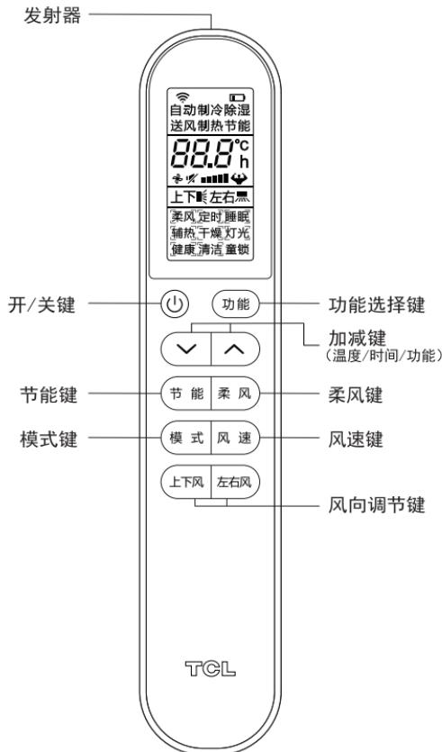
注意： 示意图中显示的所有显示部位均为显示时的状态
