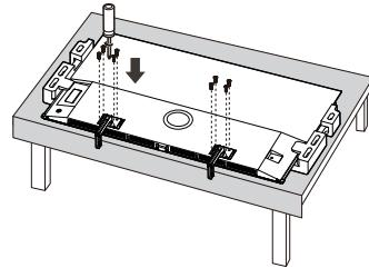
② 用挂墙螺钉将音箱挂墙底座和电视主机安装在一起
