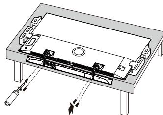
③ 用音箱螺钉从左到右将音箱和音箱挂墙底座固定在一起
