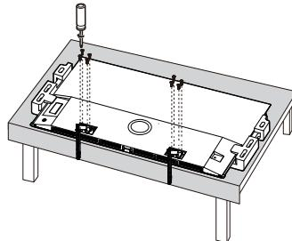
② 用底座螺钉将底座和电视主机安装在一起
