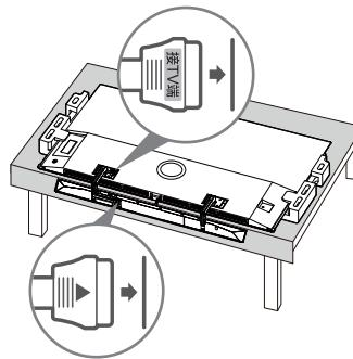
④ 将音箱转接线平整放入挂墙底座槽中，分别连接电视主机和音箱两端
