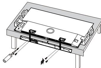
③ 用音箱螺钉从左到右将音箱和底座安装在一起
