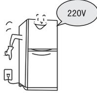
必须使用独立专用插座并进行可靠接地。本系列产品电源线配有三线（接地）插头，与标准三线（接地）插座匹配。任何情况下，切勿切除或拆除电源的第三插脚（接地）。
