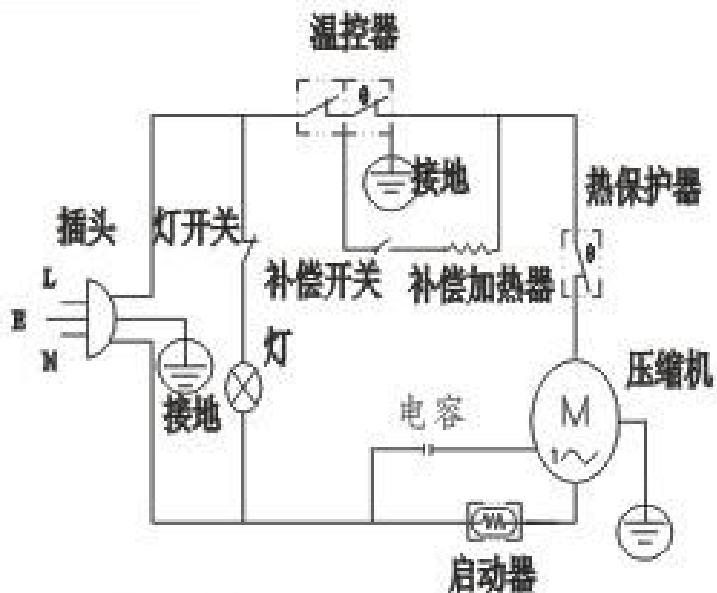
注：电容根据匹配压缩机的不同而变动
