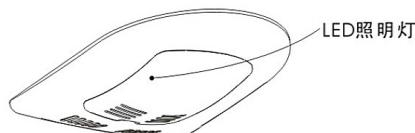
照明LED灯参数：3Vdc, 1.5W
