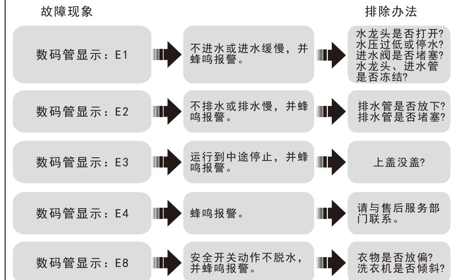
注：1. 出现故障后开合上盖可解除故障信息，故障信息解除后若仍未排除，故障在下次进程中有可能再次出现。
